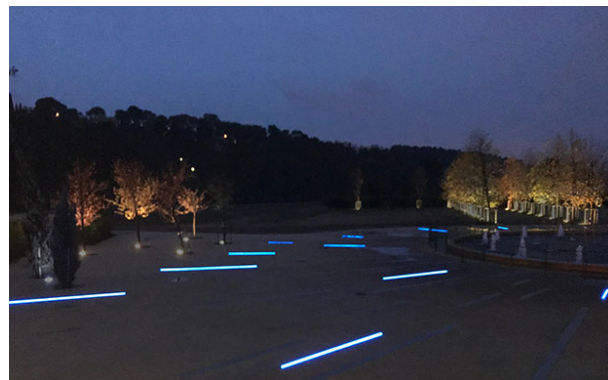
Des barreaux bleus Brunei diffusants ref 5623 sont encastrés dans le sol de la fontaine du Bocage pour représenter les rayons du soleil autour du bassin.
