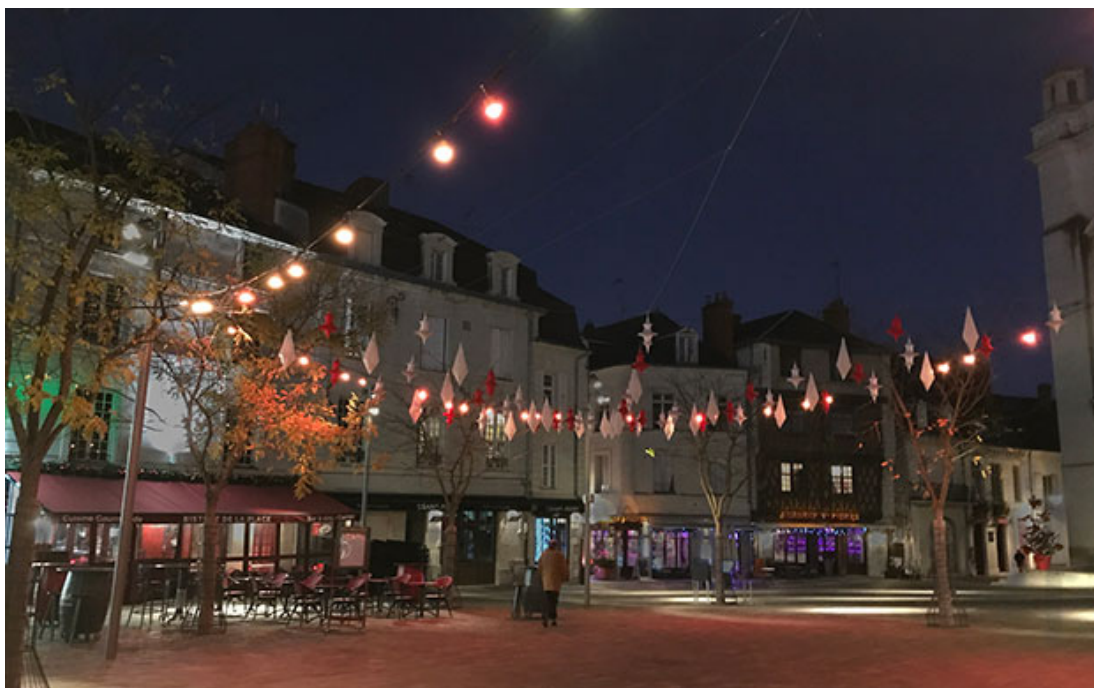
Luminaires spéciaux type guinguette - 4 lignes de 11 luminaires suspendus, en aluminium anodisé et boule sablée contenant chacune 4 led de puissance RGBW IP68
