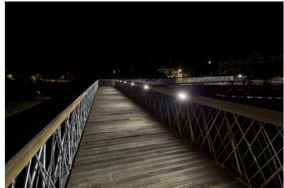
Les 45 projecteurs linéaires sont en 6 superwatts 0.8W blanc neutre, 24 VDC, Elliptique 2 - D20 orientation Est.
