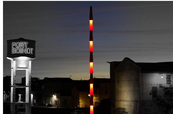
Des luminaires spéciaux, sur la base des projecteurs BORDEAUX (1530) éclairant vers le bas, installés en partie inférieure des cônes et éclairant vers le bas, créent un dégradé de lumière en luminance le long du cône et assurent l'éclairage au sol des abords.
