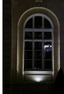
14x 5633-BE6-L3 Arches pour l'éclairage des fenêtres basses. Les projecteurs sont installés au centre du rebord de chaque fenêtre.
