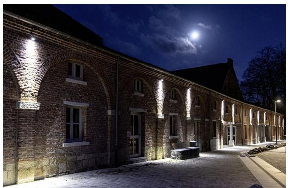
12 projecteurs Luminy2 (4020) en blanc neutre avec des optiques 20° sont implantés en hauteur pour mettre en valeur les piliers de la façade.
