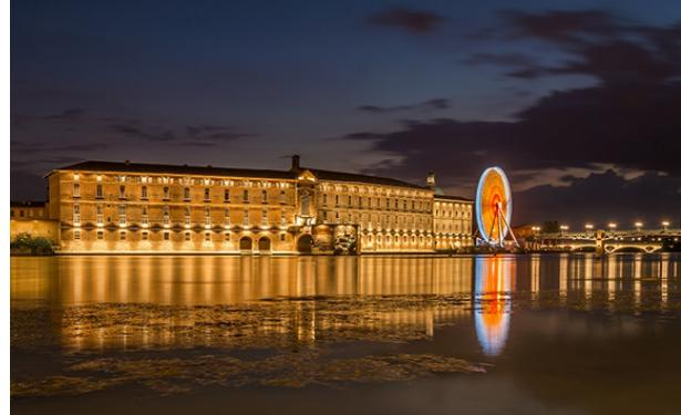
La façade de l'Hôtel Dieu a été équipée de 118 projecteurs 4660-Corsica à 42 LED de forte puissance en blanc chaud, équipés d'une optique adaptée au projet et fixés sur des potences sur mesure selon les emplacements.
