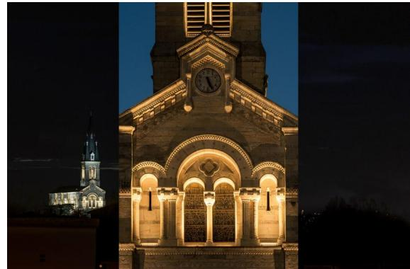
4 projecteurs linéaires de la famille CLEM - 565x de 70cm de long (réalisés sur mesure pour ce projet), montés sur des pattes de fixation orientables permettent la mise en valeur des baies centrales du clocher.
