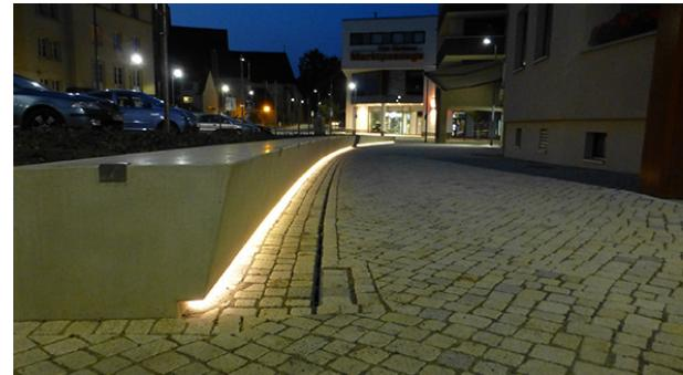
58,5 mètres linéaires (27 de 2m + 2 de 1.05m + 1 de 0.70m + 1 de 1.65m + 1 de 0.40m) de 5620-PE80 Brunei sont encastrés au banc.
