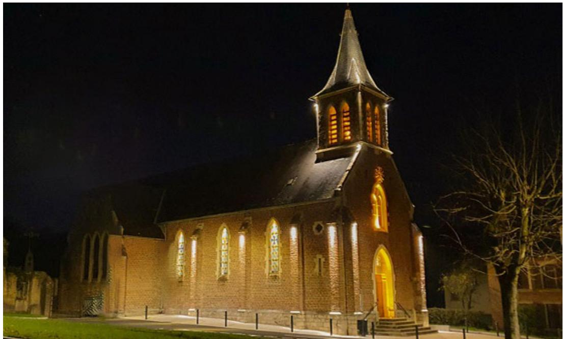
Plusieurs types de luminaires LEC ont été installés pour éclairer et sublimer l'église de Saint-Maurice; des Luminy (4020) pour un éclairage de haut en bas afin de souligner la façade et les arrêtes du clocher, des Clem (5651) pour l'intérieur du clocher, des Arches (5633) pour sublimer les vitraux et des Albi (5712) pour mettre en valeur le porche.
