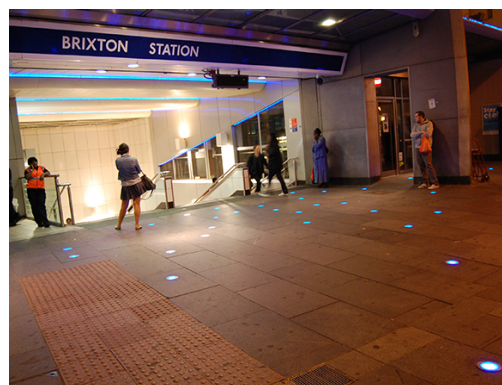
42 balises 2855-Meteor à LED bleues orientées à 120°
